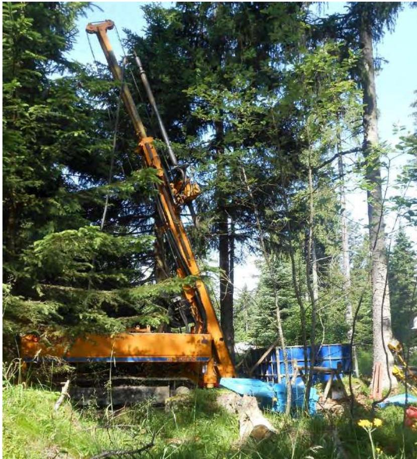
Figure 5 : Exemple de foreuse carotteuse autotractée, utilisée en 2013 par la société Aurania **dans l'un de ses projets exploration en Suisse**
