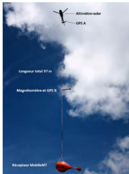
Figure 2 : Schéma de fonctionnement d'un relevé électro-magnétique par antenne MMT sous un hélicoptère (source : Levé électro-magnétique effectué en 2021 par Aurania sur son **permis d'exploration en Equateur**)
